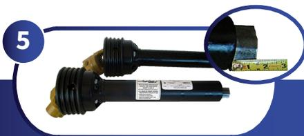
5 Vuelva a montar las mitades de la protección. Ambos tubos de perfil deben sobresalir 40 mm del extremo de los tubos de la protección.
