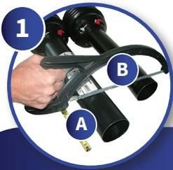
1 Retire la protección y separe las mitades de la línea de transmisión. Acorte las mitades de la protección, fig. 1) y las mitades del tubo perfilado, fig. 2 a la longitud deseada.
