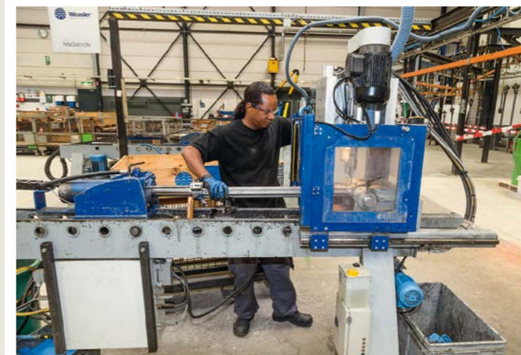
An diesem Montageplatz werden Schieberohr und Gelenkstück zusammengepresst und mit einem Spannstift fixiert. Fotos: Tovornik
