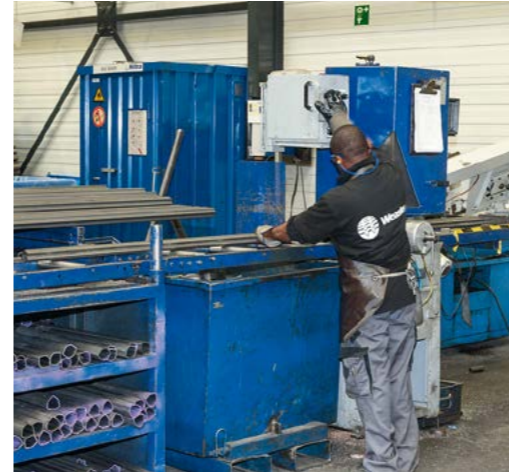
Beim Ablängen der Schieberohre wird darauf geachtet, dass möglichst wenig Verschnitt übrig bleibt.
