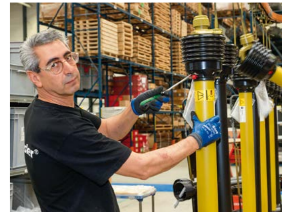
Mit einem Klick auf den Easy-Lock-Verschluss wird das Schutzrohr auf der Gelenkwelle fixiert.
