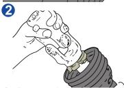
Deslize a metade da proteção sobre o cardan e coloque as abas dos Anéis dentro das aberturas da proteção
