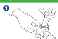
Limpe e engraxe o rasgo do anel antes do anél ser colocado no rasgo. Engraxe qualquer anél remanescente na proteção.
