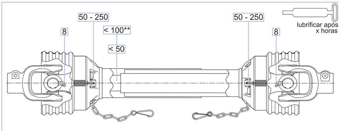
\* todos os intervalos de lubrificação dependem de aplicação
