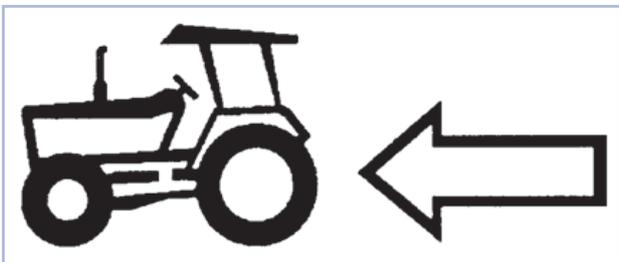
Figura C: Monte o eixo cardan com uma seta, caso esteja marco na proteção plástica) apontado para o trator.
