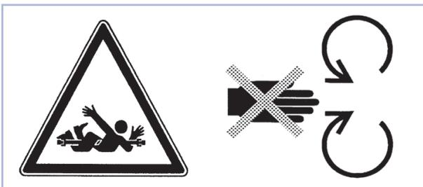
Figura B: Não abra ou remova a proteção plástica de segurança enquanto o eixo cardan estiver funcionando!
