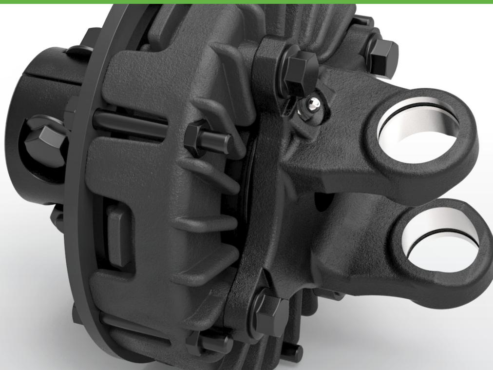
*Ce limiteur à friction est le seul à continuer de transmettre la puissance lorsqu'il y a une surcharge de couple. Il agit durant les phases de démarrage d'une machine à forte inertie, également pendant les cycles d'utilisation de la machine.*
