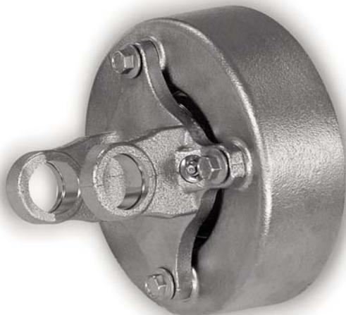
*A embreagem automática MODULAR oferece um nível de proteção de sobrecarga aos implementos que não é possível com outros tipos de embreagens. O design eficiente desconecta a fonte de alimentação do sistema de transmissão quando a sobrecarga ocorre, e não volta a ligar até que a velocidade é reduzida. Durante o desengate, o design patenteado minimiza os picos de torque prejudiciais e de calor.*
