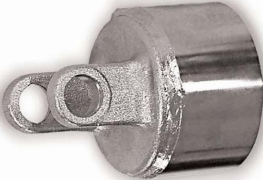
*A embreagem compacta automática oferece um nível de proteção contra sobrecarga ao implemento a qual não é possível com outros tipos de embreagens. O design compacto e eficiente desconecta a fonte de alimentação do sistema de transmissão quando ocorre sobrecarga, e não reconecta até que a velocidade é reduzida. Durante o desengate, o design patenteado minimiza picos de torque prejudiciais e de calor.*
