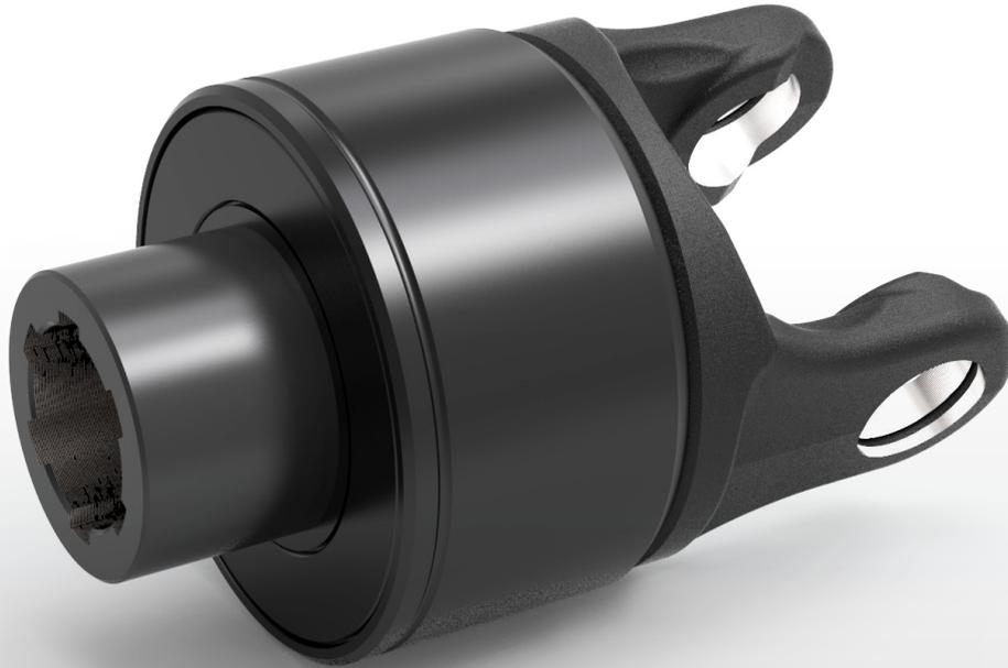
*Die kompakte Nockenschaltkupplung mit effizientem Design unterbricht den Kraftfluss bei Überlastung und schaltet diesen wieder automatisch ein, bei einer definierten niedrigeren Drehzahl. Während der Loslösung lässt der patentierte Entwurf keine schädlichen Drehmomentspitzen oder Hitzeentwicklungen zu.*
