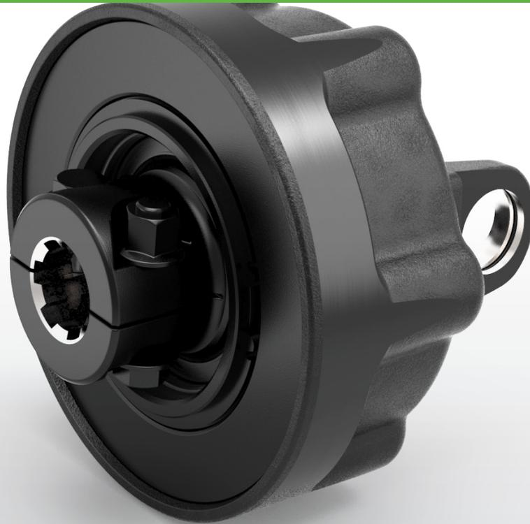
*Die integrale Nockenschaltkupplung unterbricht den Kraftfluss bei Überlastung und schaltet diesen wieder automatisch ein, bei einer definierten, niedrigeren Drehzahl. Während der Loslösung lässt der patentierte Entwurf keine schädlichen Drehmomentspitzen oder Hitzeentwicklungen zu*
