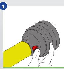
Den Easy Lock Schmiernippel in Position drücken. Das Lager und die Sicherung sind nun fixiert. Die Schutzvorrichtung muss sich auf der Gabel frei drehen lassen.
