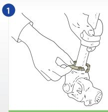
Den Lagerring säubern und fetten, bevor das Lager in die Nut gesetzt wird.
