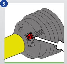
Entfernen der Schutzvorrichtung – Den Easy Lock Schmiernippel mit einem Schraubenzieher lösen. Das Lager drehen um es aus dem Schutz zu lösen und die Schutzvorrichtung entfernen.
