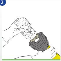
Die Easy Lock Schutzvorrichtung über die Gelenkwelle schieben und die Lagerstellen in die Öffnungen drücken
