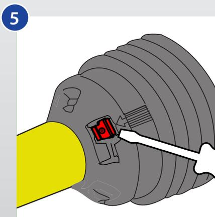
5 Démontage - Utiliser un tournevis et déverrouiller le clip Easy Lock. Faire pivoter la bague, puis retirer le protecteur
